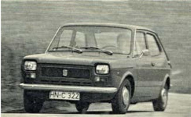
**Drei Sätze Reifen brauchte der Fiat 127 im Verlauf des Dauertests. Stahlgürtelpneus mit kleinen Schräglaufwinkeln passen am besten zu dem Fronttriebler.**
