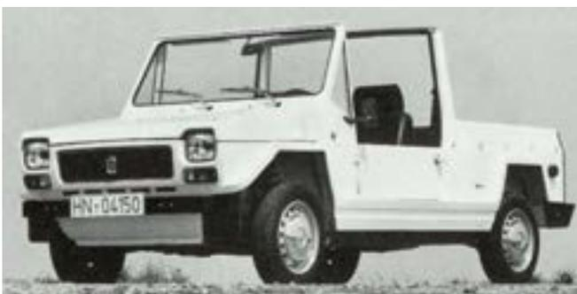
Der Scout 127 ist ein leichter Geländewagen mit hohem Nutz- und Freizeitwert. Hersteller ist Fissore, einer der renommierten italienischen Karoserieschneider. Der Aufbau ist «Ganzstahl» auf der technischen Basis des Fiat 127. Besonders findet der Scout 127 Einsatz in der Forst- und Landwirtschaft, in Handel und Industrie. Der Scout 127 ist mit einem abnehmbaren, winterfesten Allwetterverdeck ausgestattet, ein Hardtop ist lieferbar.
